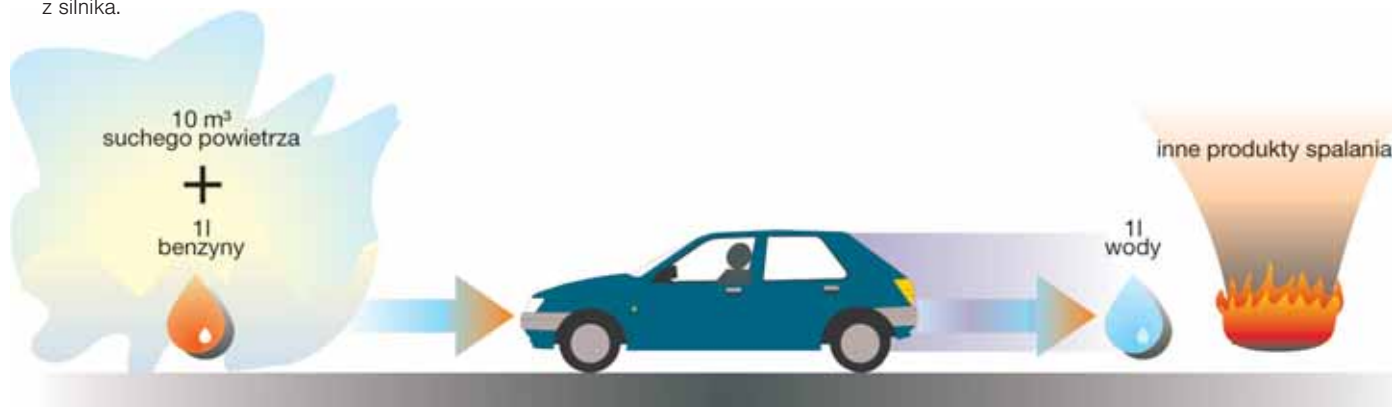
Spalenie jednego litra paliwa to jeden litr wody powstałej w rezultacie spalania
